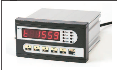
VISUALIZZATORE TIPO SA01 IMPOSTAZIONI DA TASTIERA RISOLUZIONE FINO A 60000 DIV.
